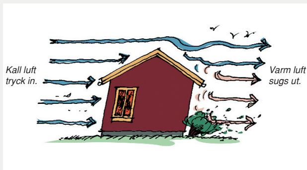
Figur 3. FTX-system ska installeras för att effektivt återvinna värmen i ventilationsluften. För att det fungera är det dock nödvändigt att väggar, tak och fönster är riktigt lufttäta, annars kan man tappa 33 % av energibesparingen.
